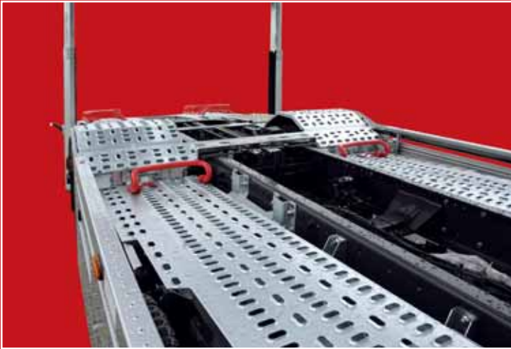
Die an der unteren Etage hydraulisch absenkbaren Fahrbahnschienen garantieren eine optimale Ladehöhe.
