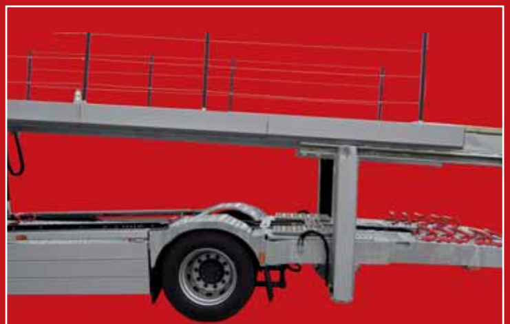
Hubvorrichtung hinten in hochfester Stahllegierung für schnelle Be- und Entladung.
