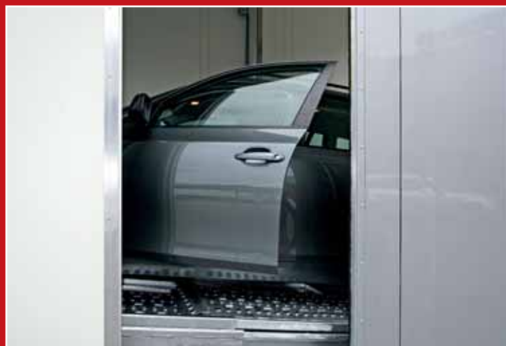
Die Türen der verladenen Fahrzeuge können aufgrund der Anordnung der seitlichen Türen des Sattelauflegers komfortabel geöffnet werden.
