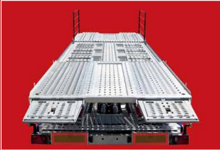
Hebebühne mit außenliegenden Zylindern – wie alle Kässbohrer Fahrzeuge in vollverzinkter Ausführung.
