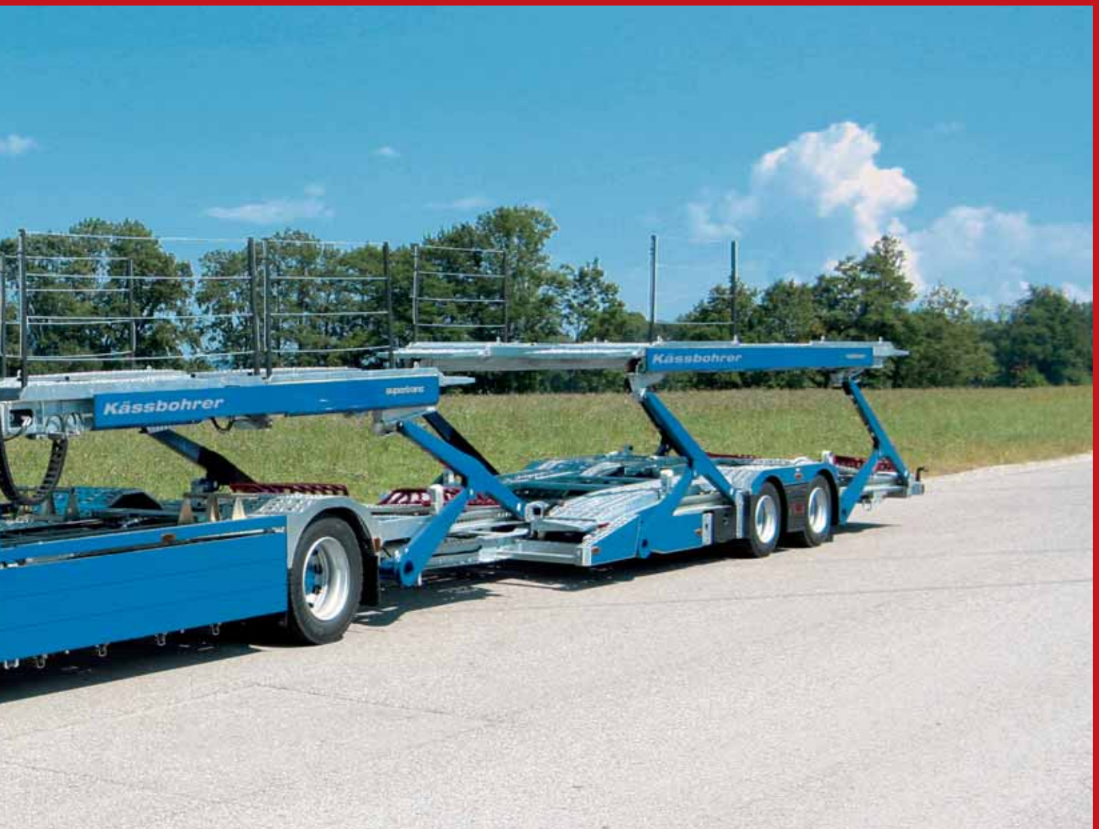
Hebebühne mit außenliegenden Zylindern – wie alle Kässbohrer Fahrzeuge in vollverzinkter Ausführung.
