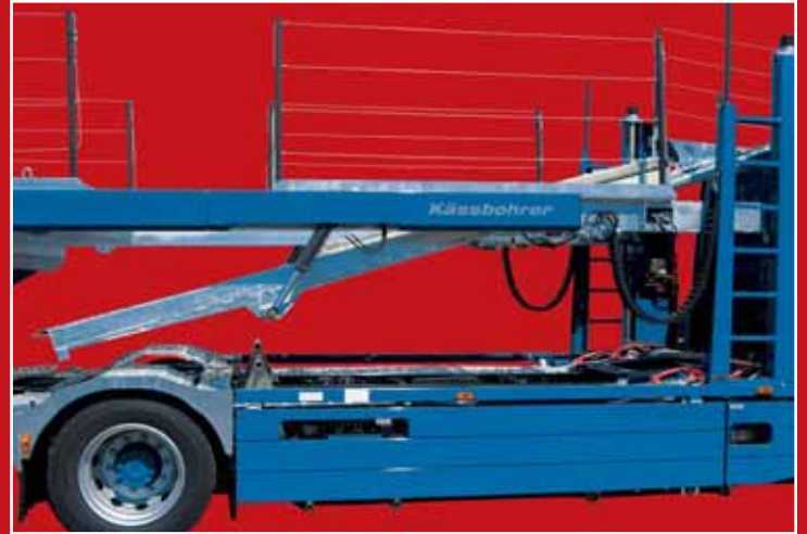
Hebebühne mit integrierter Zwischenbühne ermöglicht das Beladen von bis zu fünf Fahrzeugen am Motorwagen.
