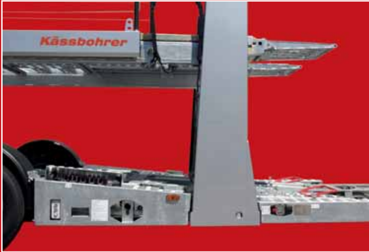
Säulengruppe am Anhänger vorne mit Spindelhubgetriebe für optimale Hubleistung.
