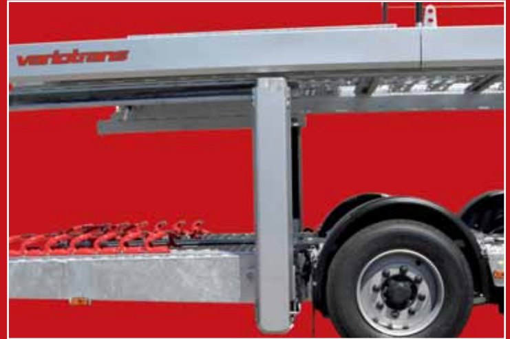
Hubvorrichtung hinten in hochfester Stahllegierung für schnelle Be- und Entladung.
