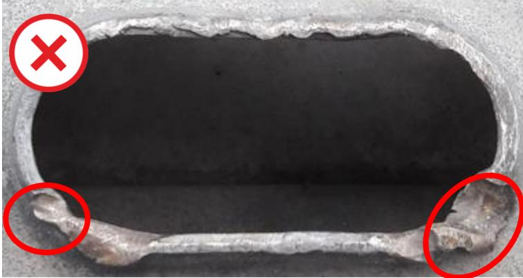
Klappe mit Mulde: Risseinleitung, durch Kerbbildung
