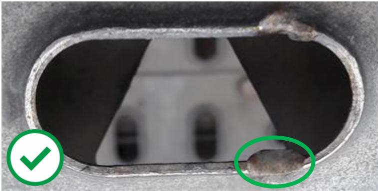
Klappe mit Mulde: Quetschung durch Fließen von Material
