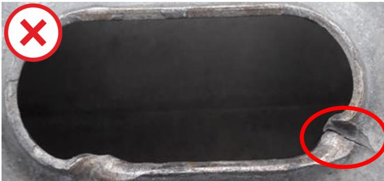
Klappe mit Mulde: Rissfortführung, durch Schwellspannung
