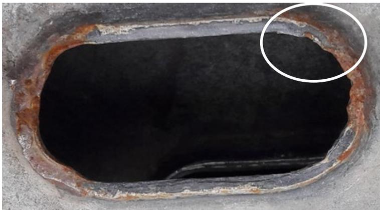
Kotflügelblech: Materialabtragung durch Fließen
