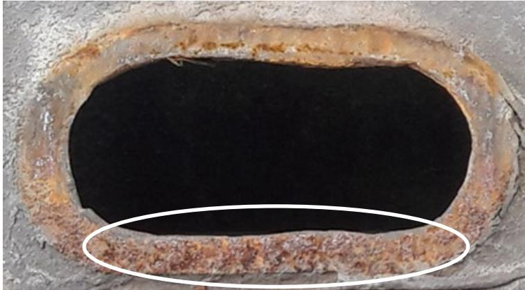
Kotflügelblech: Materialabtragung durch Reibung
