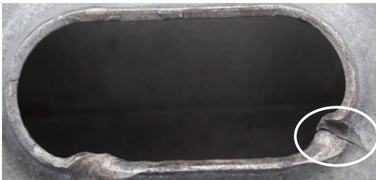
Klappe mit Mulde: Rissfortführung, durch Schwellspannung
