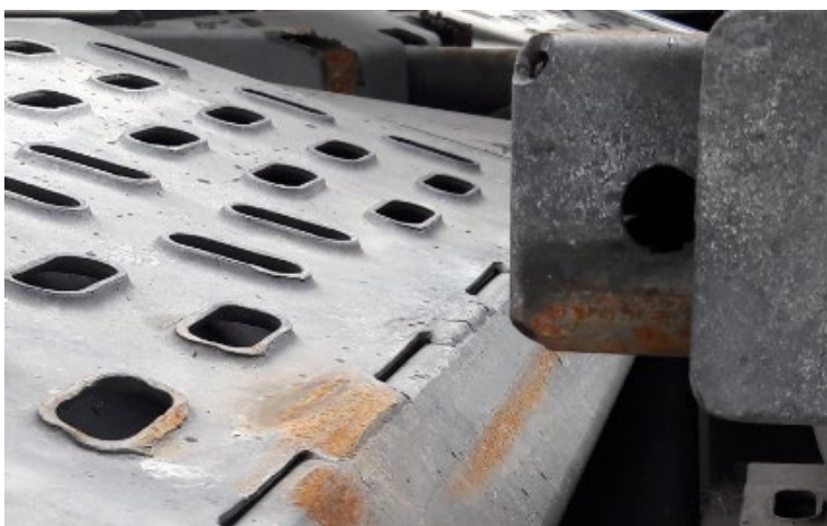
Stapelplateau: Reibung des Stapelplateaus auf Fahrbahnblech
