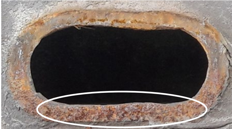
Kotflügelblech: Materialabtragung durch Reibung
