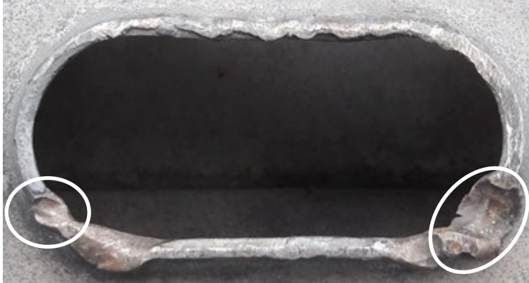
Klappe mit Mulde: Risseinleitung, durch Kerbbildung
