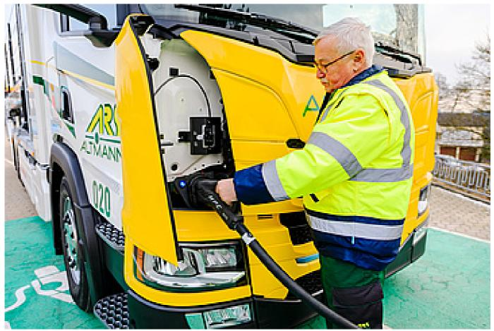
Klappe auf, Stecker anschließen und schon startet der Ladevorgang. In weniger als 90 Minuten bei maximal 130 kWh (CCS 2) ist der Transporter voll aufgeladen.
