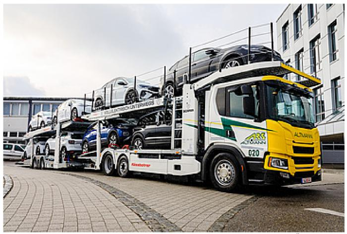
Der erste vollelektrische Standard-Autotransporter von Scania transportiert ohne Überlänge oder Überhöhe bis zu acht Pkw.
