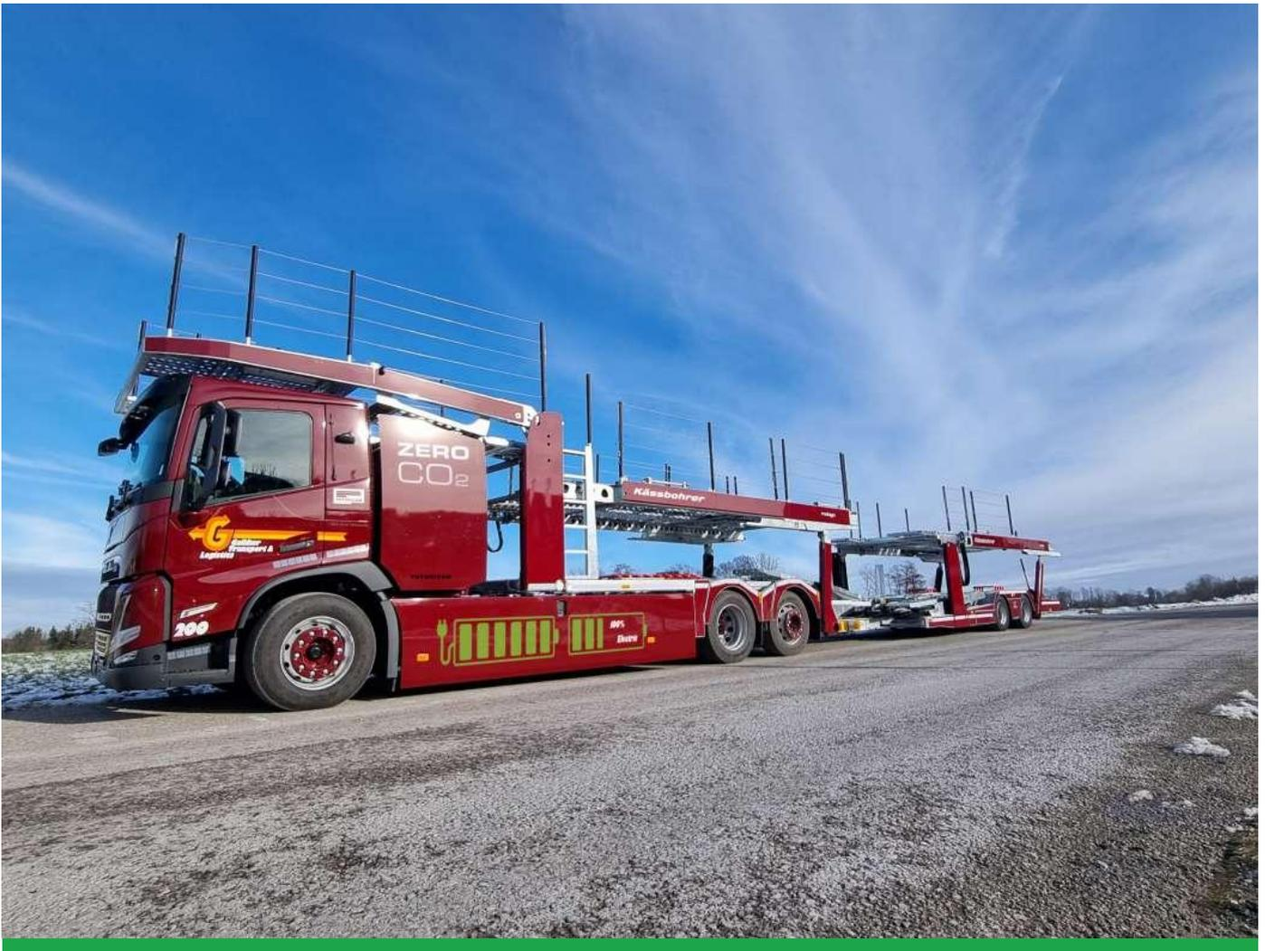
Der Volvo FM mit Kässbohrer-Aufbau besitzt ein erhöhtes zulässiges Gesamtgewicht und einen verlängerten Motorwagen.
