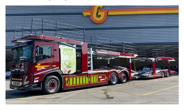
Die maximale Nutzlast des Carporter 26E liegt bei neun Tonnen. Der Anhänger mit Überfahrplateau kommt auf zehn Tonnen Nutzlast. Insgesamt kann das 19,75 Meter lange Gespann mit seinem zulässigen Gesamtgewicht von 42 Tonnen acht Pkw transportieren.
