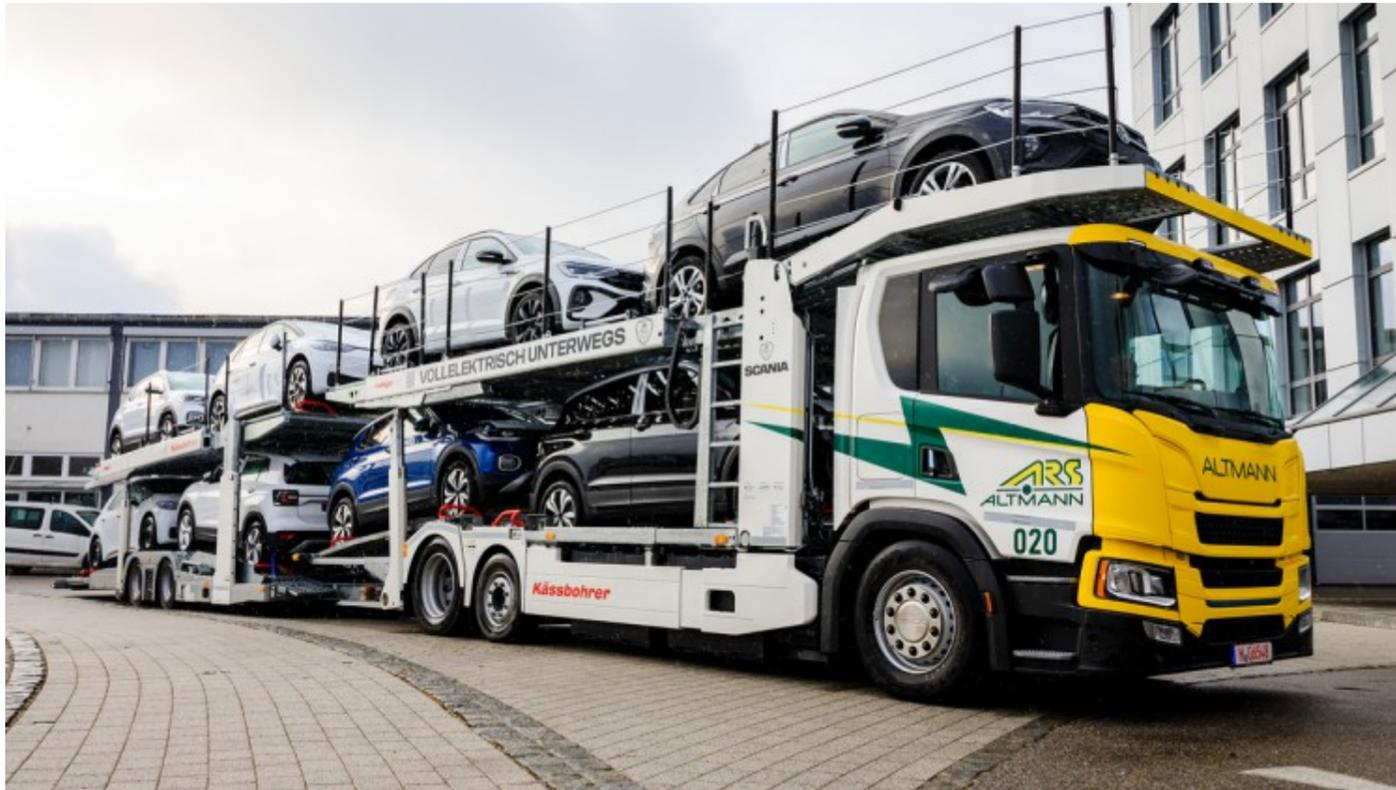
Der Elektro-Scania kann bis zu acht Pkw transportieren und soll auf Strecken bis 150 Kilometer Länge zum Einsatz kommen
