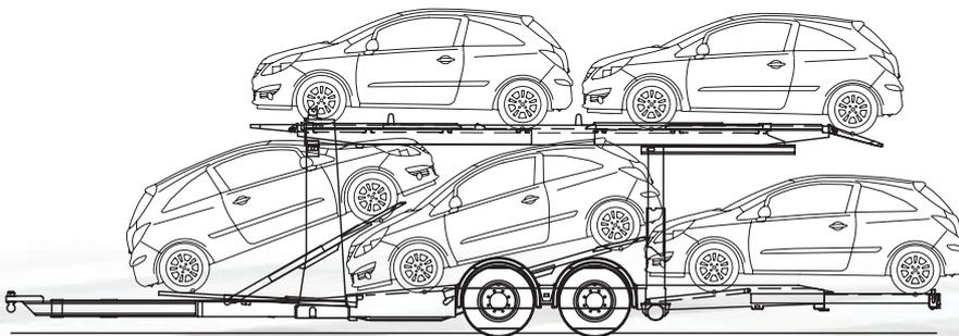
Esempio di caricovariotrans®procon 4,00 m di altezza.
